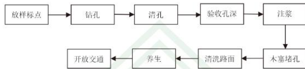
图 7-2 注水泥浆加固施工工艺流程图
